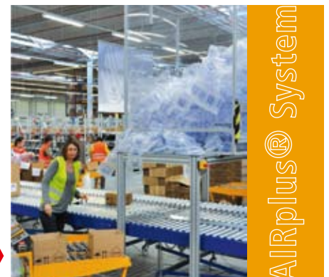
Die AIRplus® Silos stehen auf Rollen und sind ebenso beweglich wie die Packwagen. ➤
